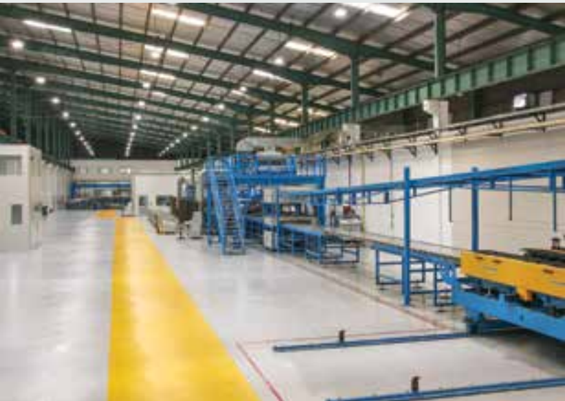
Dây chuyền sản xuất Panel (PIR) xuất xứ Italia có công nghệ hiện đại đang hoạt động tại Nhà máy sản xuất Panel - Công ty CP Greenpan.
